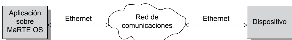
Figura 3.2: Sistema común para control y recepción de imágenes con red de por medio.
