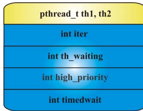
Figura 3.21 Señales: Estructura de datos para los threads
